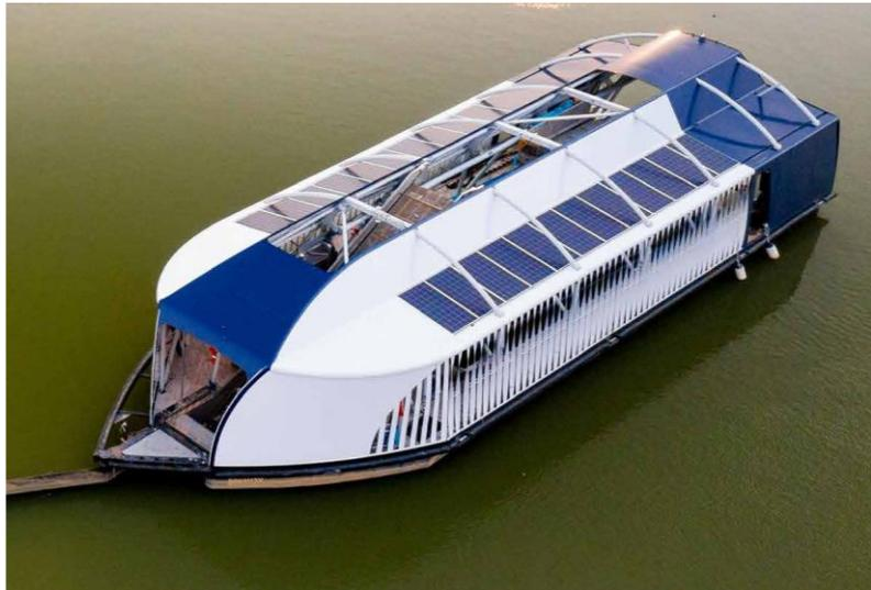
Gambar 4. Alat *interceptor*<sup>™</sup> Generasi 04
