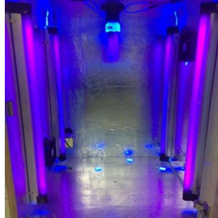
Gambar 5. Hasil perancangan reaktor fotokatalis dalam kondisi menyala
