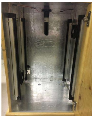
Gambar 4. Hasil perancangan reaktor fotokatalis dalam kondisi off
