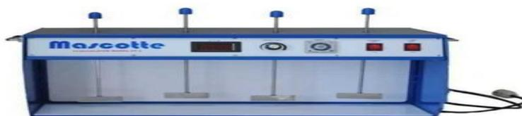
Gambar 12. Uji jar test
